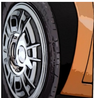
Cromodora 'abgewinkelter' Zentralverschluß
